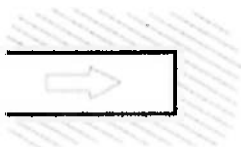
Mergulho das descontinuidades concordante com a direção da galeria
