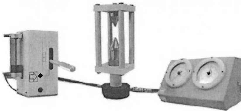
Figura 9: Equipamento utilizado no ensaio do Point Load Test
