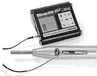
Figura 11: Equipamento utilizado no ensaio de Martelo Schmidt
