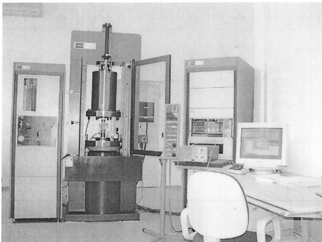
Figura 8: Equipamento utilizado no ensaio de resistência à compressão uniaxial
